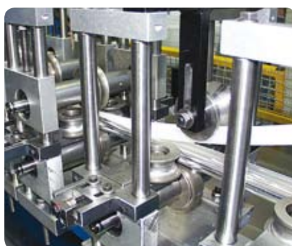
Fig 9. Wrapping unit Courtesy of Maillefer SA / Dreistern
